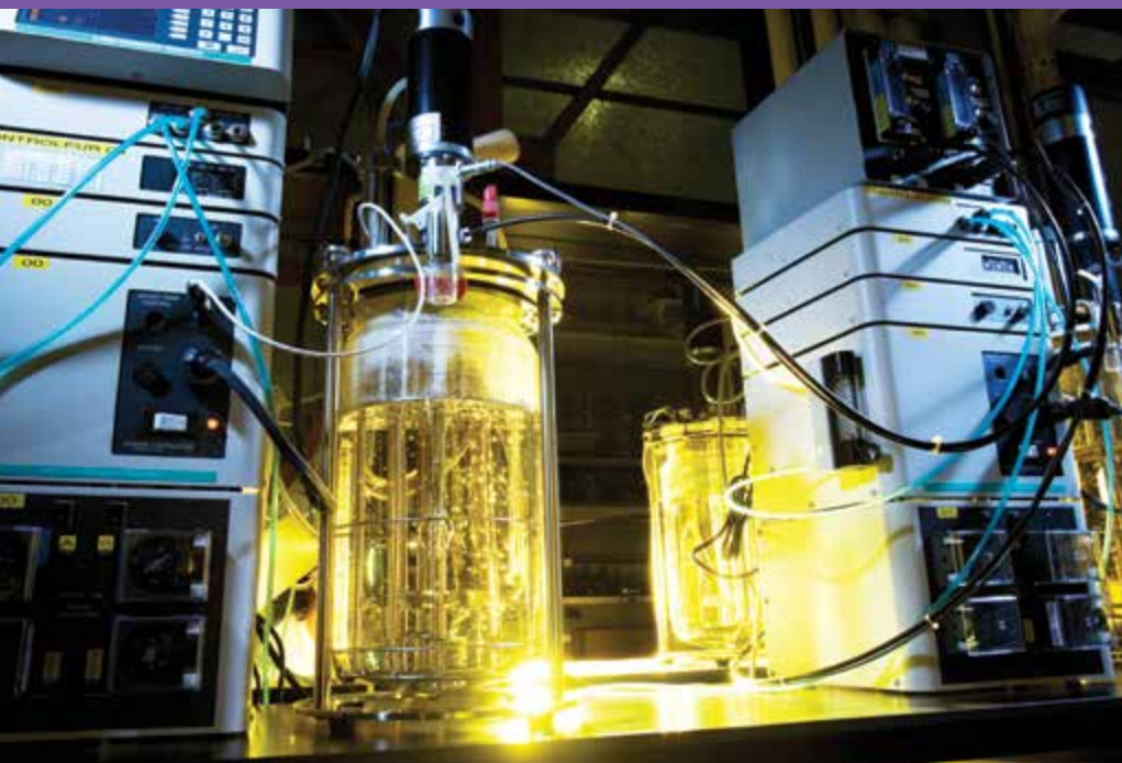
Bioréacteurs modulaires à l'échelle laboratoire pour le développement de procédés accélérés et intégrés à l'échelle pilote.
